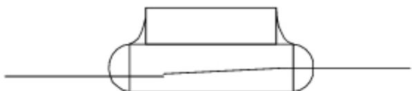
D. Bistabil. Der Reed-Schalter schliesst bei Annäherung eines Magneten den Kontakt und bleibt dank des vorinstallierten Magneten geschlossen, bis sich ein Magnet mit gegensätzlicher Polarität annähert.
