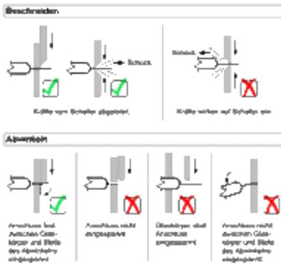
Bei unsachgemäßem Kürzen bzw. Biegen der Anschlussenden wirken erhebliche mechanische Belastungen auf die Einschmelzzone ein, die zu Glassprüngen führen können. Es ist dafür zu sorgen, dass der verbleibende Teil zwischen Glaskörper und Schnitt- bzw. Biegepunkt so eingespannt wird (Glaskörper frei beweglich), dass diese Probleme vermieden werden.
