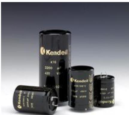
Die 11 Snap-In Elektrolyt-Kondensatoren Serien des Herstellers Kendeil decken den Spannungsbereich von 16 bis 600 VDC und einen Kapazitätsbereich von 68 bis und mit 47000  $\mu\text{F}$  ab. Erhältlich sind die Kondensatoren mit Standard-Temperaturbereichen von -40 bis +85 und +105 °C. Eine Variante mit tieferem Bereich von bis -55 °C ist in Vorbereitung.
