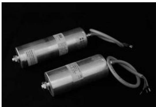
Die Ex-Kondensatoren sind mit Betriebsspannungen von 280, 420 und 470 Volt AC lieferbar. Die verfügbaren Kapazitätswerte erstrecken sich von 1 bis 30  $\mu\text{F}$  bei 420 und 470 VAC und 1 bis 55  $\mu\text{F}$  bei 280 VAC. Die Kondensatoren sind innert zwei bis drei Wochen, in Kleinmengen, lieferbar.
