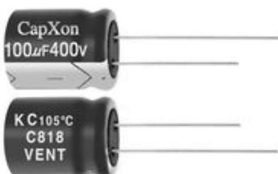
Die KC-Serie mit 105 °C Betriebstemperatur und einer Lebenserwartung von (3'000 Stunden (Load Life; bei voller Belastung) ist die miniaturisierte Variante der Standard-Serie KM. Bei verkleinertem Gehäuse beinhaltet sie mehr Kapazität und kann mit höherem Ripplestrom belastet werden. Bei Nennspannungen von 400, 420 und 450 VDC sind Kapazitäten von 82 bis 220 µF lieferbar.
