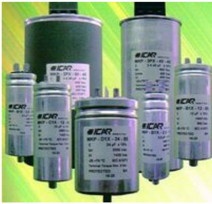
Die neu entwickelte Leistungskondensatoren-Serie MKP von ICAR wurde speziell für Filter-Anwendungen bei Wechselspannungen von 300 bis 850 VAC konzipiert. Angeboten werden die Filter-Kondensatoren in einer einphasigen Variante (1X) mit Betriebsspannungen von 300 bis 850 VAC sowie als dreiphasige Variante (3X), mit 450 bis 850 VAC.
