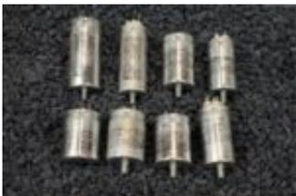
Die Kondensatoren für den Einsatz in Heizungen sind thermisch gefordert. In den Heizungsanlagen herrschen oft hohe Temperaturen vor und eine aktive Kühlung der Komponenten ist nicht vorhanden.
