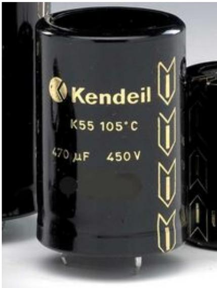
Mit einer Ausfallrate von nur 40 FIT (Failure in time; 40 Ausfälle pro  $10^9$ /Stunden) und einer durchschnittlichen Lebensdauer von 250'000 Stunden bei 40 °C (mit spezifiziertem Ripple-Strom) sind die Kondensatoren optimal für den Einsatz in Solar-Wechselrichtern geeignet.
